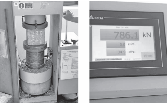
Hình 3. Thí nghiệm cường độ chịu nén
